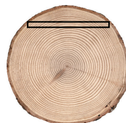
Técnica de laminagem, corte tangencial
